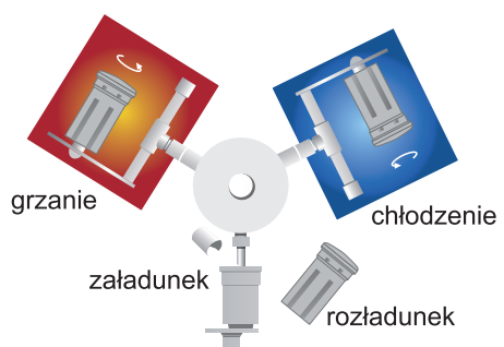
Rys. 2.1 Schemat procesu odlewania rotacyjnego na przykładzie maszyny karuzelowej
